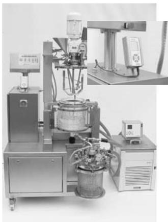
**Wireless TEMP utilisé sur un mélangeur EL-pm**
